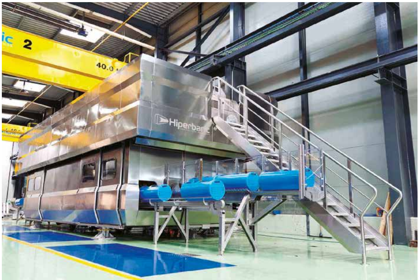
Equipo para Prensado en Frío. Foto: Hiperbaric.
