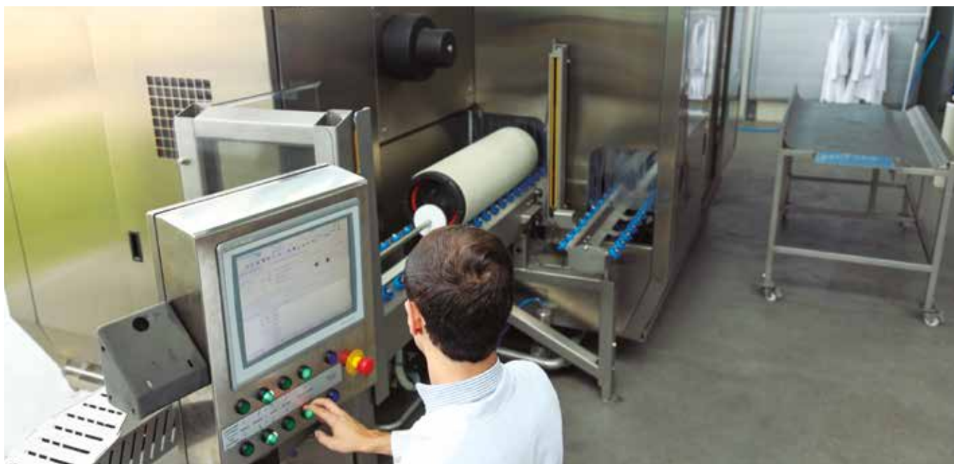
El contenedor es capaz de soportar condiciones extremas de presión de hasta 6.000 bares. Foto: Hiperbaric.
