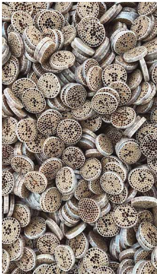
Relleno colonizado. Foto: Cimico.
