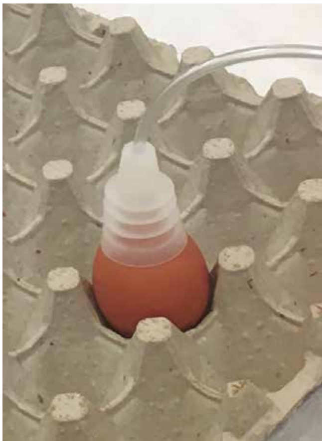
Los investigadores adaptaron ventosas utilizadas para la manipulación industrial de huevos. Foto: Tom Turpen, Sensit Ventures.
