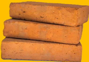
El tabique rojo común es económicamente mas viable que un block de concreto. Además de ser agradable visualmente y ambientalmente si se le proporciona el acabado adecuado para dejarlo aparente.
