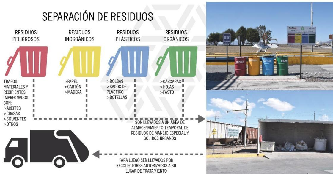
Los residuos peligrosos como la metoninia, la colina, la grasa, el fungicida, los condensados, el combustóleo y el diésel pueden ser accidentalmente derramados en la planta por alguna fuga o acción imprevista, por lo que, son recolectados con arena para posteriormente almacenarlos temporalmente en recipientes especiales para su traslado a plantas de tratamiento correspondientes.
